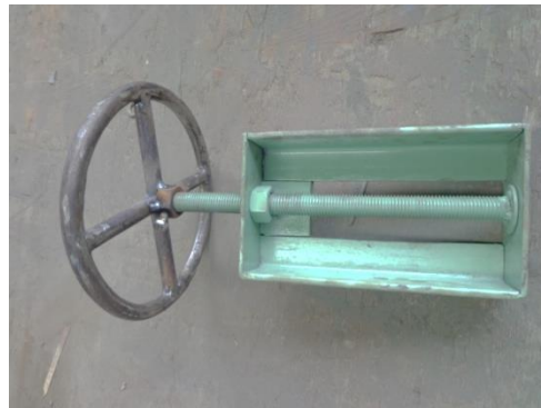
FIGURA N°3.25 “CONSTRUCCIÓN DEL MECANIZMO DE REGULACIÓN”
