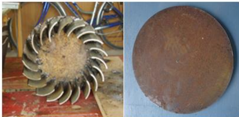
FIGURA N°3.24 “CONSTRUCCIÓN DEL RODETE”
