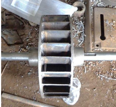
FIGURA N°3.14 “CONSTRUCCIÓN DEL RODETE”
