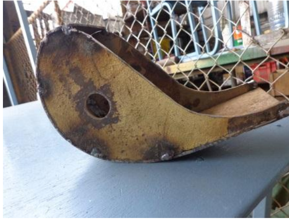
FIGURA N°3.23 “CONSTRUCCIÓN DEL ÁLABE DIRECTOR”
