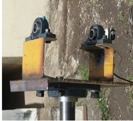
Figura 3. 29 Bases de aerogenerador
