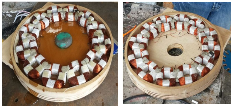
Figura 3. 26 Bobinas cubiertas de resina
