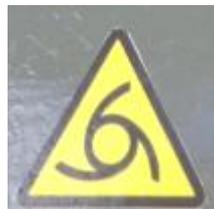
Indica que el sistema se operado automáticamente
