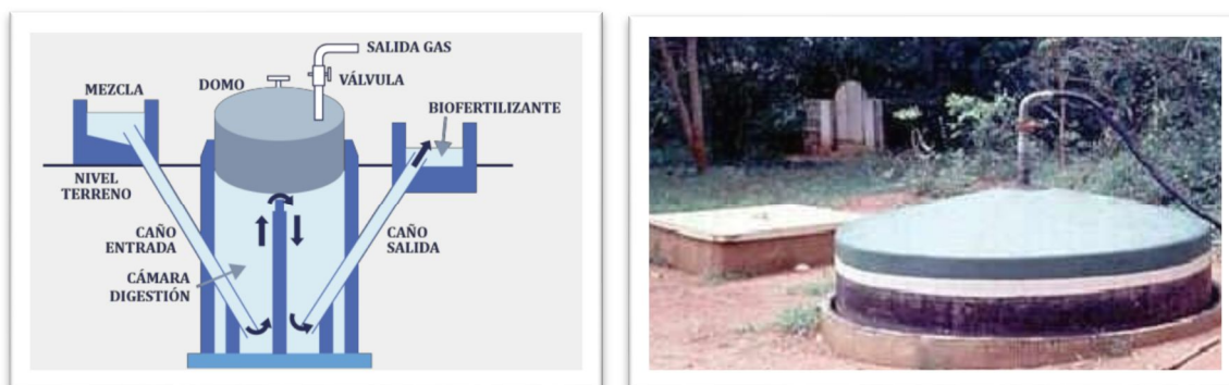
Figura 0-2 Biodigestor anaerobio de cúpula flotante y detalles de la cúpula.
