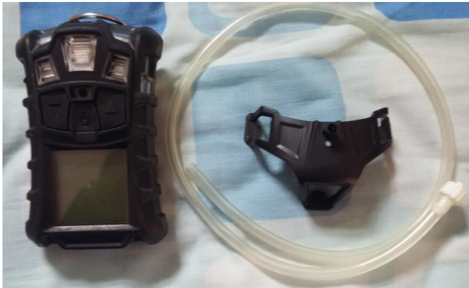
Ilustración 13: Analizador de Gases
