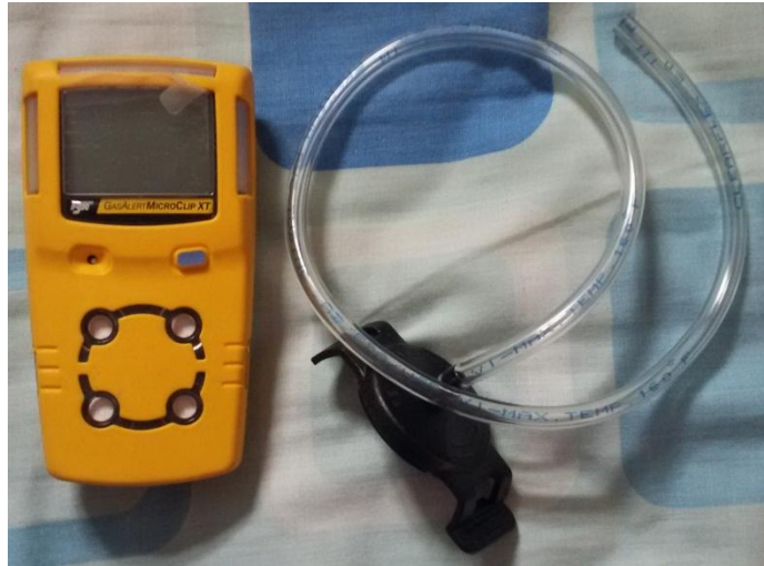
Ilustración 14: Analizador de Gases
