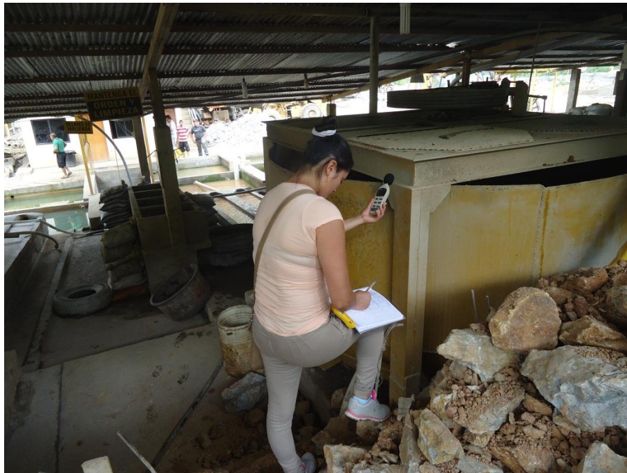
Ilustración 26: Medición de Ruido Área de Molienda y Trituración (Molino 3)
