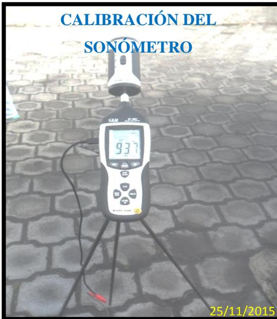
**CALIBRACIÓN DEL SONÓMETRO**
