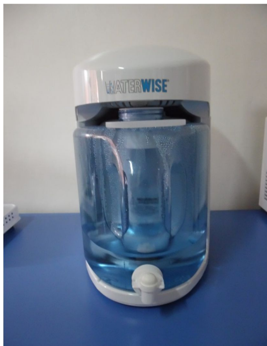
Fotografía 2. Destilador de agua waterwise 9000.
