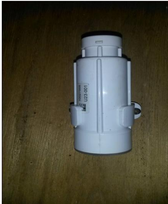
FOTOGRAFÍA N° 36. Registro de la temperatura y humedad relativa con el hobo (Tipanluisa, 2015)
