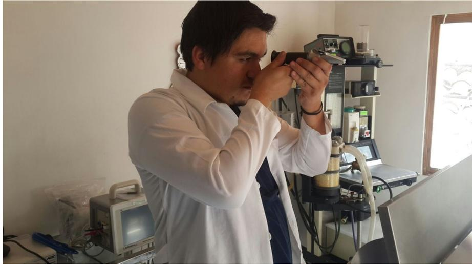
Utilización del refractómetro para la lectura de la densidad de la muestra de orina
