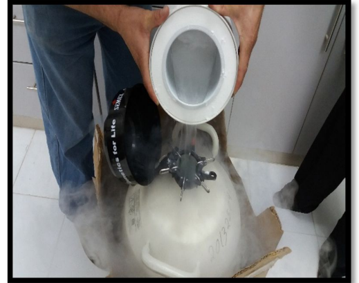
FOTO 16. TRASLADO DE LAS PAJILLAS A UN TERMO CON NITROGENO L.
