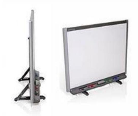
El panel de la pizarra está formado por dos capas separadas, la exterior es deformable al tacto. La presión aplicada facilita el contacto entre las láminas exteriores e interiores, provocando una variación de la resistencia eléctrica y permite localizar el punto señalado. Esta tecnología es utilizada por TeamBoard, Polyvision y Smart Board.
