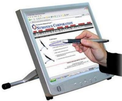
Se trata de un monitor táctil con software específico que se puede conectar a cualquier ordenador; permite hacer anotaciones que se pueden proyectar con un video-proyector. Son adecuados para conferencias y proyecciones sobre grandes superficies.
