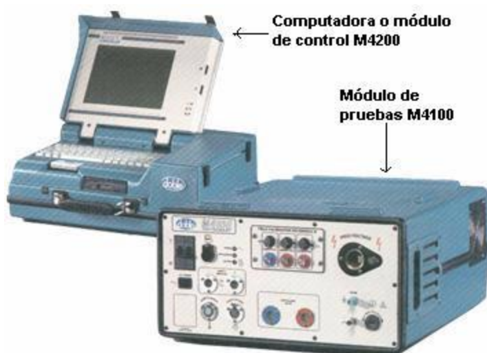
GRÁFICO N° 9 Equipo para medición de pérdidas de potencia M4000
