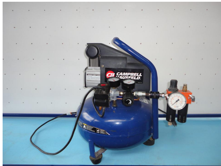
Anexo 13. Foto de la unidad de mantenimiento.
