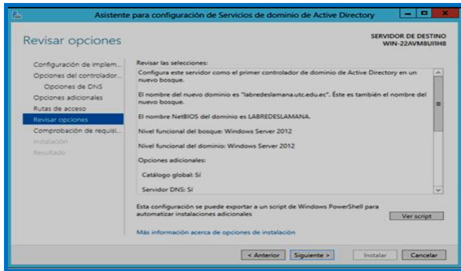
GRÁFICO N°. 3.29. PUESTA EN MARCHA DEL ACTIVE DIRECTORY EN EL WINDOWS SERVER 2012.
