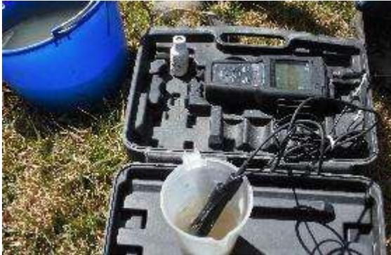
Medición de temperatura y PH
