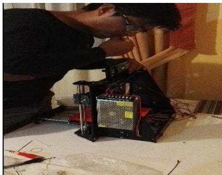
Fig. 38.- Colocación del regulador y panel de control.
