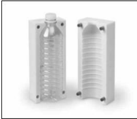
Fig. 7.- Patrón para plegado de plástico (PC).
