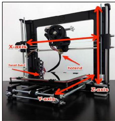
Fig. 10.- Ejes XYZ en la impresora 3D.
