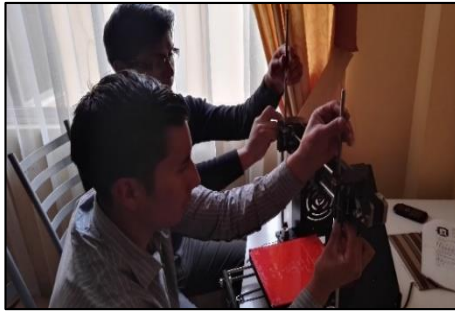
Fig. 32.- Acople de los tres ejes mediante guías y ejes roscados.
