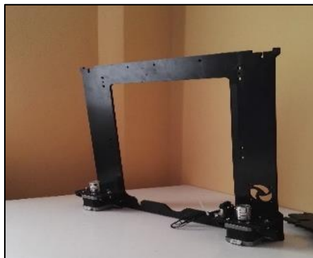
Fig. 26.- Armado de eje Z
