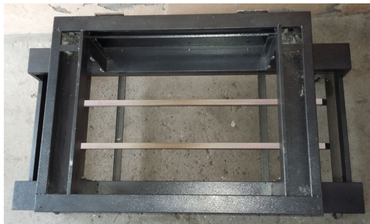
Estructura o carcasa del túnel
