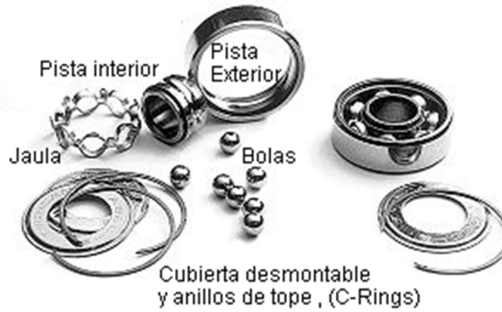
FIGURA 11 PARTES DEL RODAMIENTO
