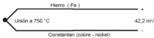
FIGURA 4 . PRINCIPIO DE FUNCIONAMIENTO DE LA TERMOCUPLA.
