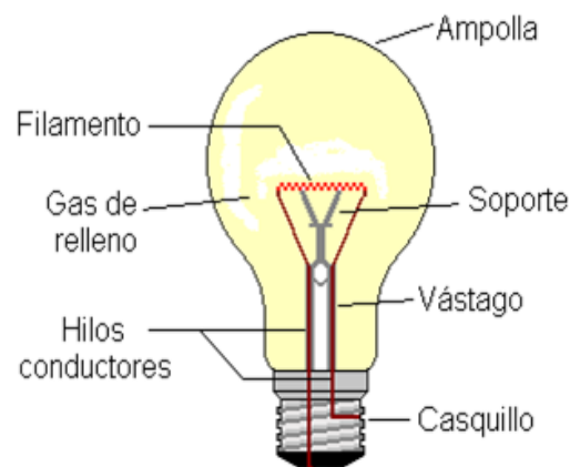
Figura 6. Partes constitutivas y tipos de lámparas incandescentes Fuente: Sistemas informáticos SOLMED (2013)
