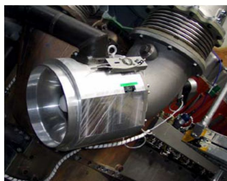
Figura N° 8 Mezclador de aire Biogás
