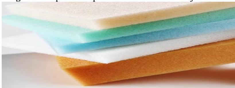
Figura 2: Espumas de poliuretano flexibles de baja densidad
