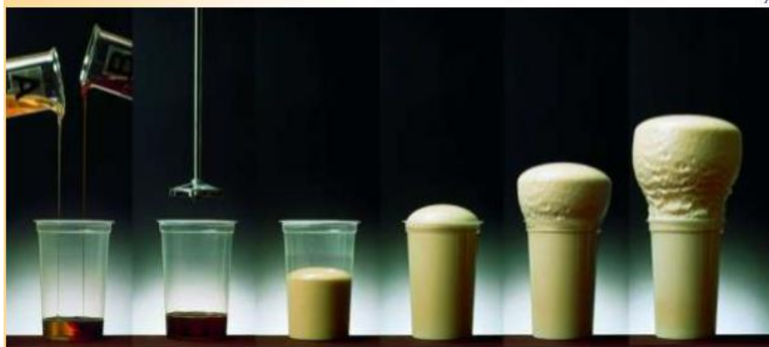
Figura 1: Proceso de espumación del poliuretano.
