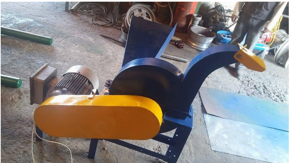
Máquina picadora automática picadora de tallos de maíz ensamblada en su totalidad
