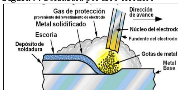
Figura 9: Soldadura por arco eléctrico
