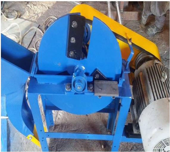
Montaje de las cuchillas y contra cuchilla
