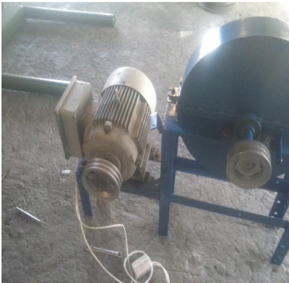
Ensamble de los elementos mecánicos y eléctricos
