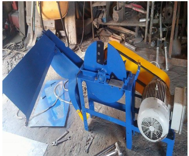
Máquina picadora automática picadora de tallos de maíz ensamblada en su totalidad
