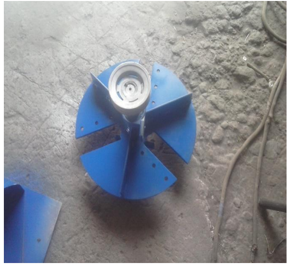
Rotor picador, cuchillas, bases del motor y tolva de salida de la caña
