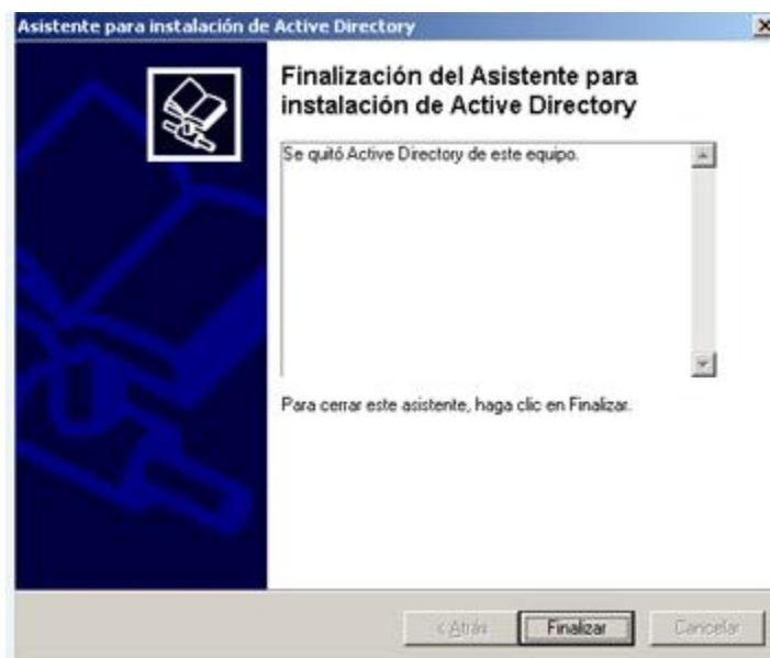
Figura 17. Dar de baja Controlador de Dominio
