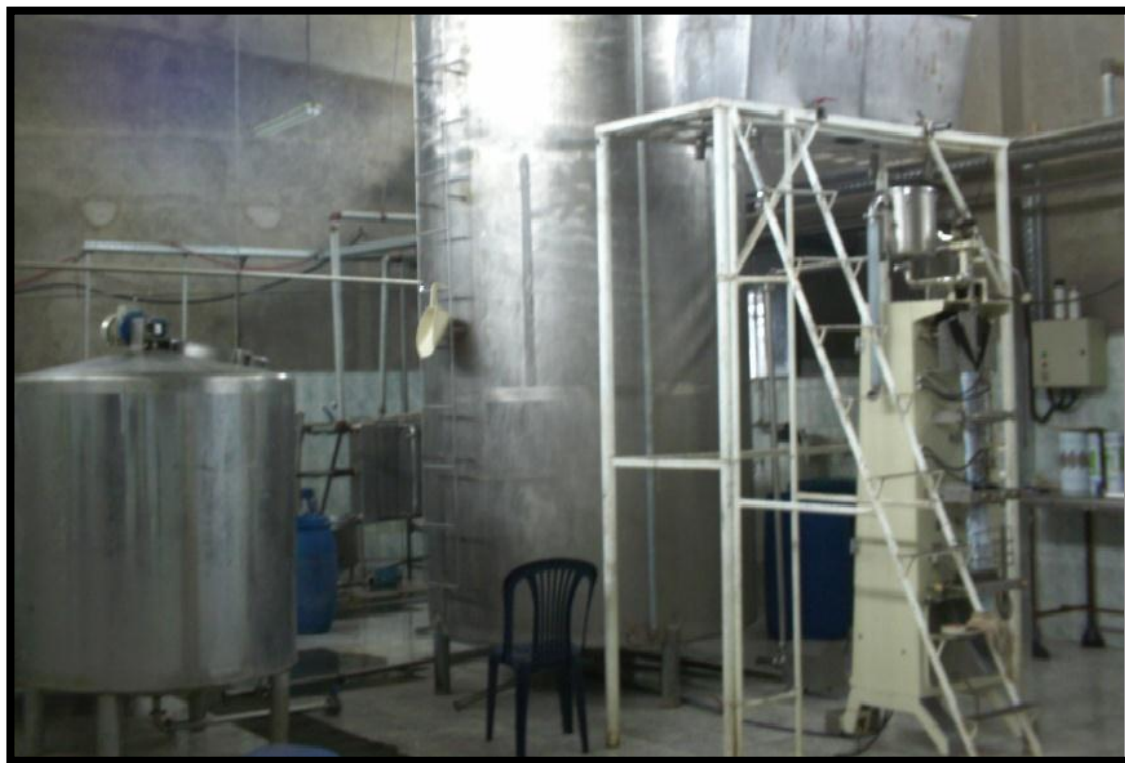
Tanque de filtración de la leche y enfundado
