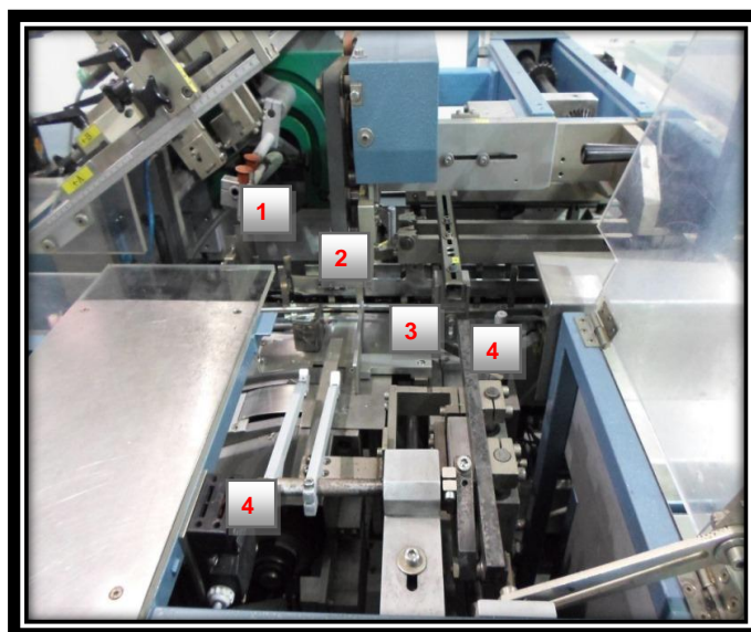
Imagen 6: Estación de entrada de blíster al estuche
