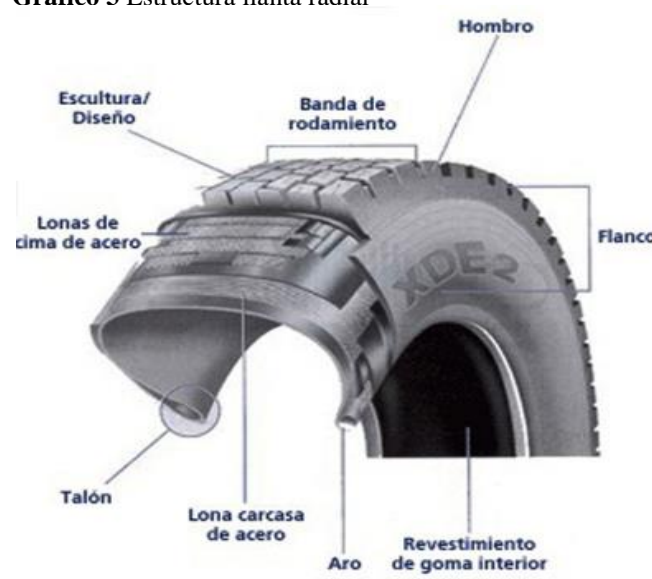
Gráfico 3 Estructura llanta radial
