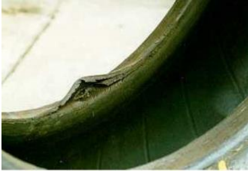
Fig.7 Daños en el aro
