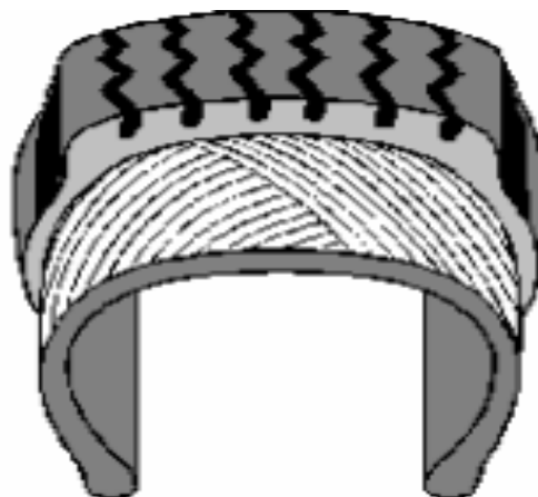
Gráfico 4 Estructura llanta convencional
