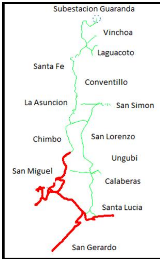
Figura N° 15 Alimentador Chimbo con subtensión
