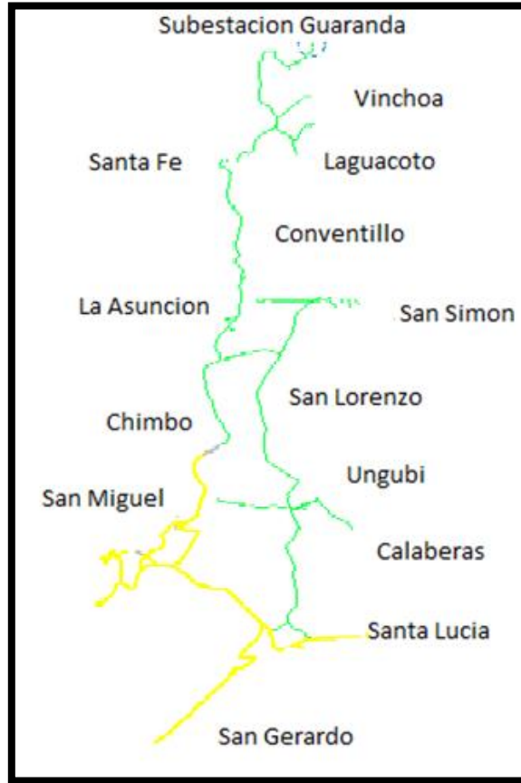
Figura N° 16 Alimentador Chimbo con sobrecarga
