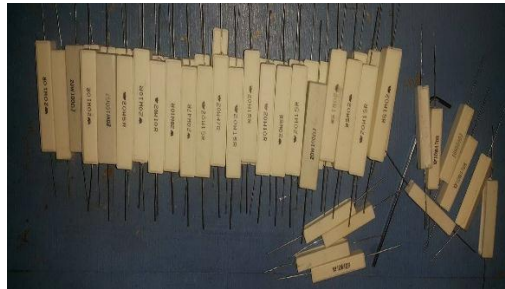
Figura 21. Resistencias de Potencia de diversos valores.
