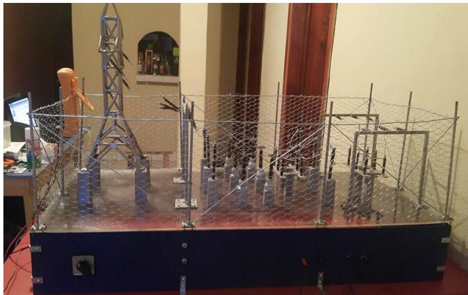
Figura 10. Prototipo de una Subestación eléctrica de Barra Simple.
