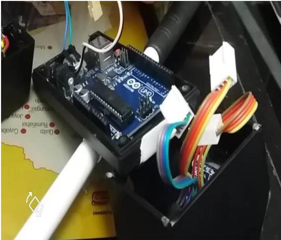
La batería que alimenta al bastón va conectada a la placa Arduino
