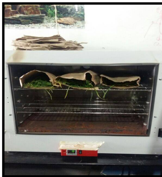
Fotografía N.- 10 Deshidratación del pasto mediante una estufa
