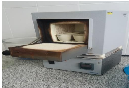
Fotografía 3. Tarado de crisoles en la mufla
