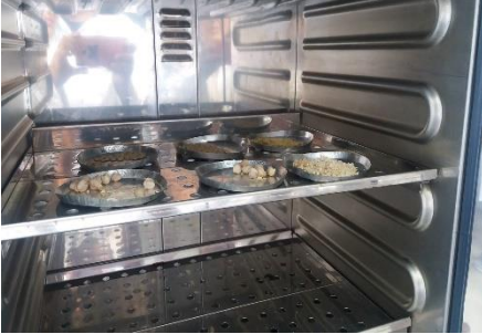
Fotografía 1: Muestras de lenteja y garbanzo en la estufa electrónica de secado.
