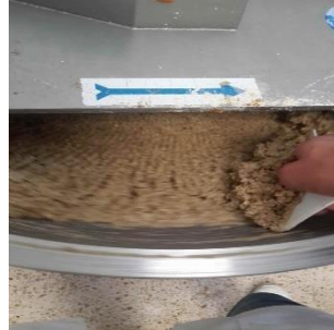
Fotografía 32. Cuteado de las materias primas
