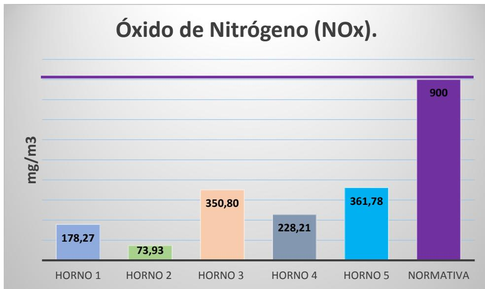
**Ilustración 4.** Emisión de Óxido de Nitrógeno (NO<sub>x</sub>) y comparación con la normativa.
