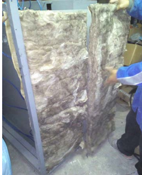
Figura N°23: Colocación de lana de vidrio en el secador
