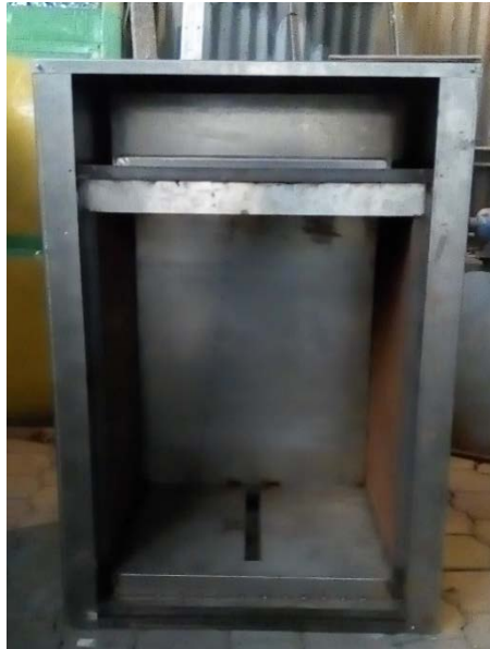
Figura N° 22: Cámara exterior del secador
