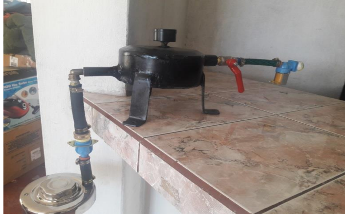
Figura 31: Sistema de transferencia de agua
