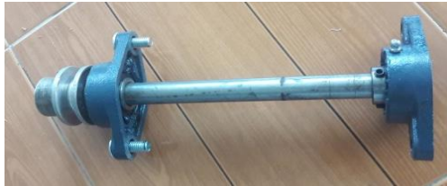
Figura 16: Eje dimensionado acoplado a los rodamientos y polea conducida
