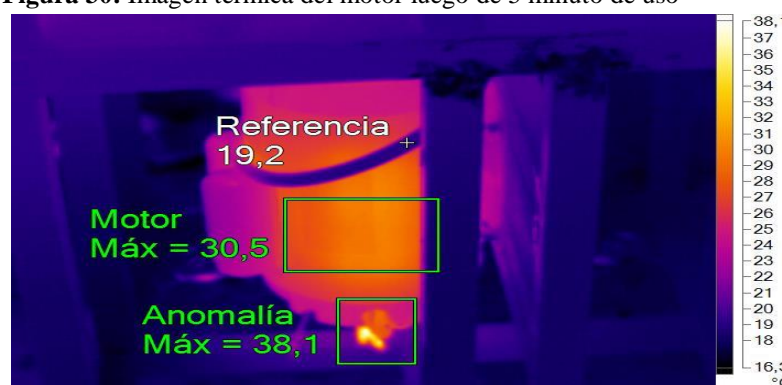
Figura 30: Imagen térmica del motor luego de 5 minutos de uso
