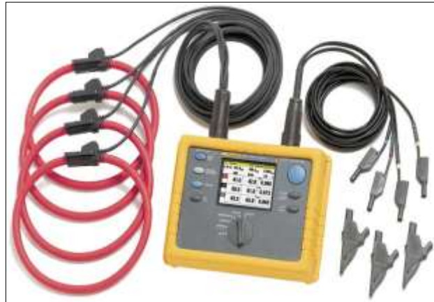
Figura 5. Analizador de energía FLUKE 1735
