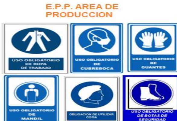
Gráfico 17: Señalización del uso obligatorio de Equipos de Protección Personal.
