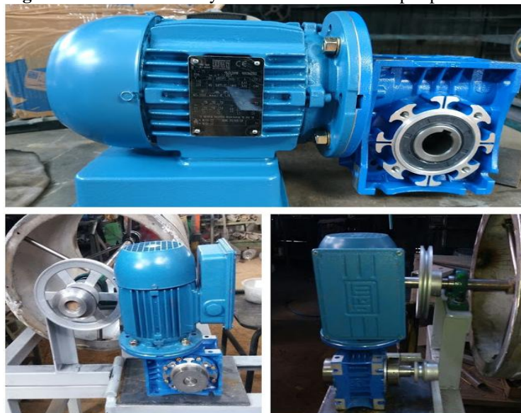
Figura 30: Motorreductor y sistema de transmisión por poleas
