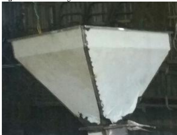
Figura 24: Tolva de ingreso
