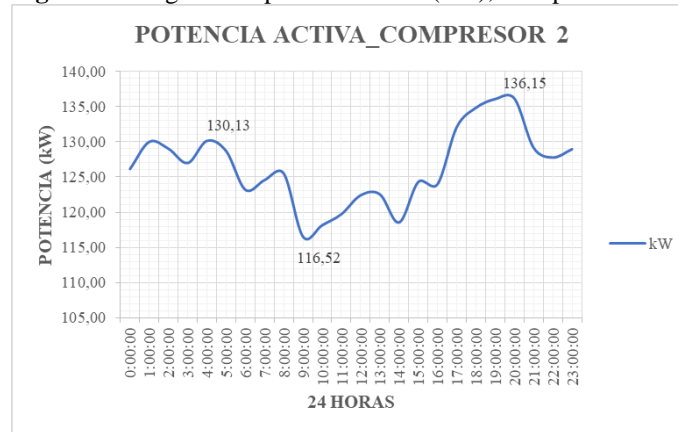
Figura 23. Registro de potencia activa (kW), Compresor 2.
