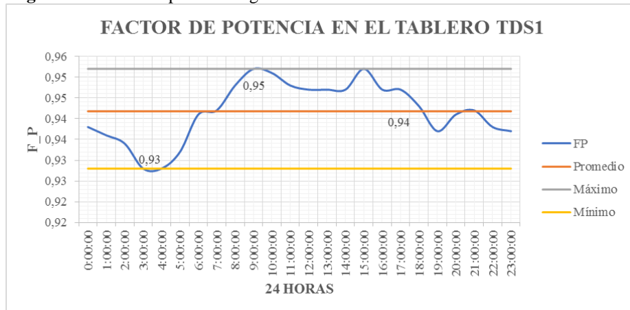
Figura 20. Factor de potencia registrado en el STD1.
