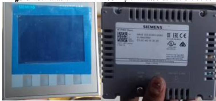
Figura 13. Pantalla HMI KTP400 Implementado del tablero de control.
