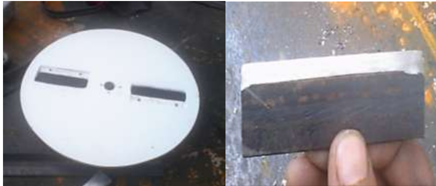
Construcción del disco y cuchilla para pruebas preliminares
