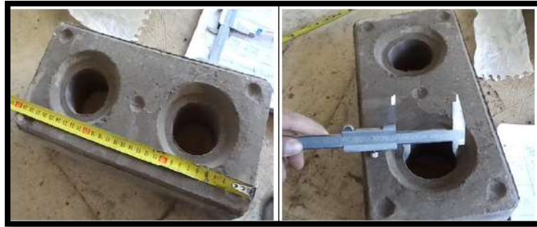
Figura 6. Ladrillo ecológico tipo lego (300 x 150 x 85) mm
