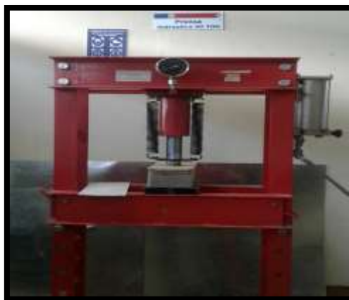
Figura 11. Prensa Hidráulica de 40 tons, modelo T54001
