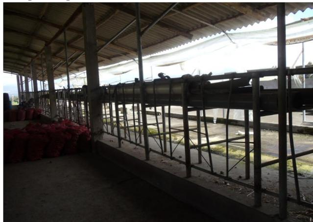
Los cerramientos exteriores comprenden paredes de mampostería y vallas metálicas que no se han levantado completamente. La cubierta es de plástico con estructura de vigas metálicas y madera
