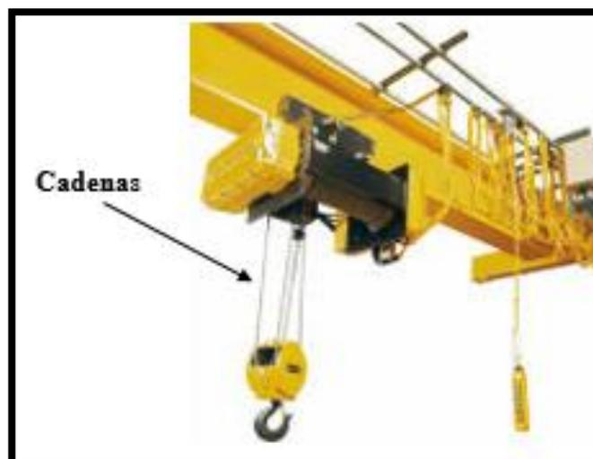
**Figura 11.-** Cadenas del puente grúa
