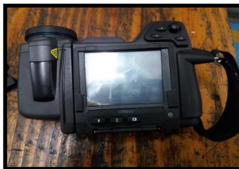
**Figura 3.- cámara termográfica (FLIR)**
