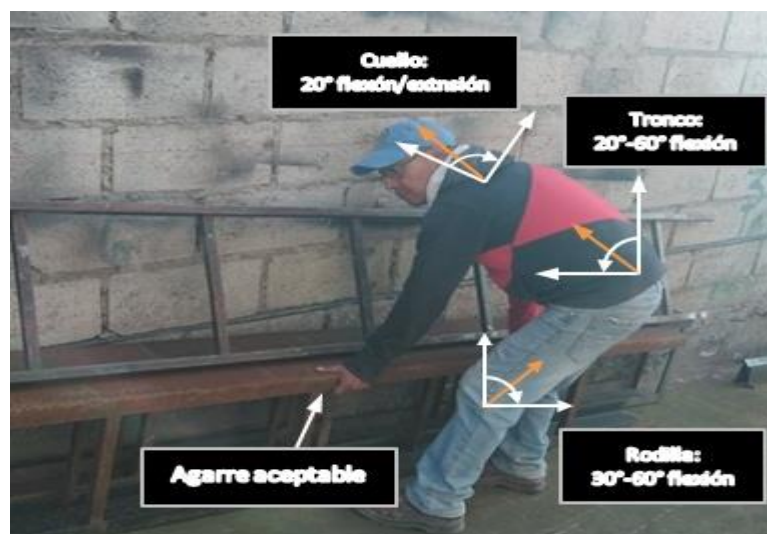
Foto 4. Operario levantamiento de vigas.
