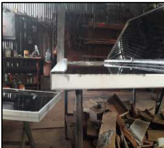
Foto 5: GERMINADOR LISTO PARA LA SOLDADURA
