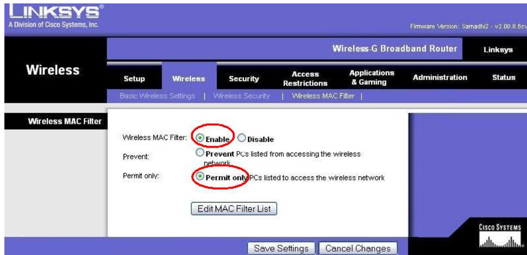
Fig. 23 Habilitar filtro MAC
