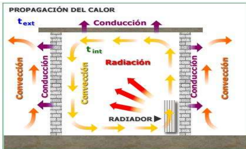
Figura 1. Esquema de los mecanismos de transferencia de calor
