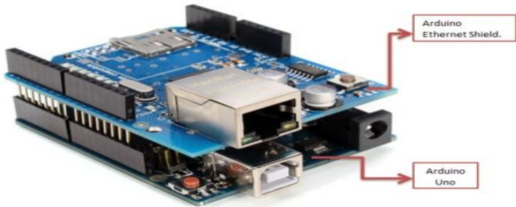
Figura 11. Montaje del módulo shield Ethernet en el Arduino Uno
