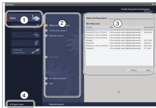
Figura 12: Vista del portal
