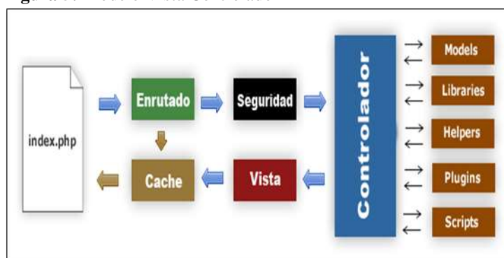
Figura 5: Modelo Vista Controlador
