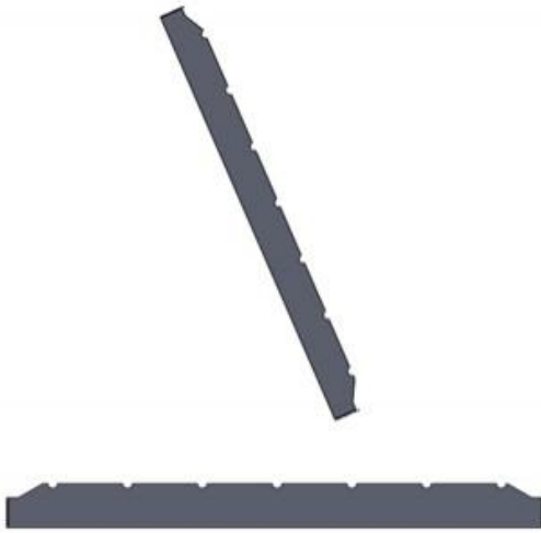
Fig. 3.6 Representación del modelo 3D de la base de la resistencia eléctrica utilizada en el prototipo de horno.
